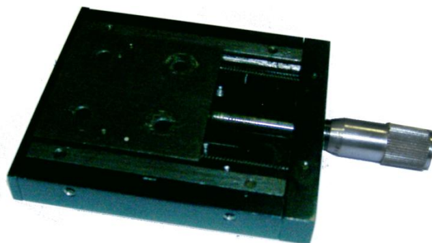
Figura 46 – Estágio de Translação utilizado e o Parafuso micrométrico.
