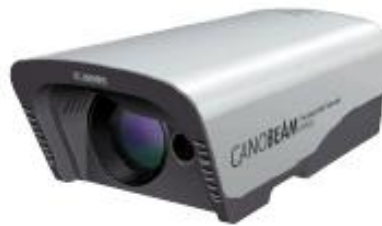
Figura 2 - Equipamento DT-130 fabricado pela Canon Inc. Taxa de transmissão de 1,25Gbps, alcance de até 2km e sistema de rastreamento.
