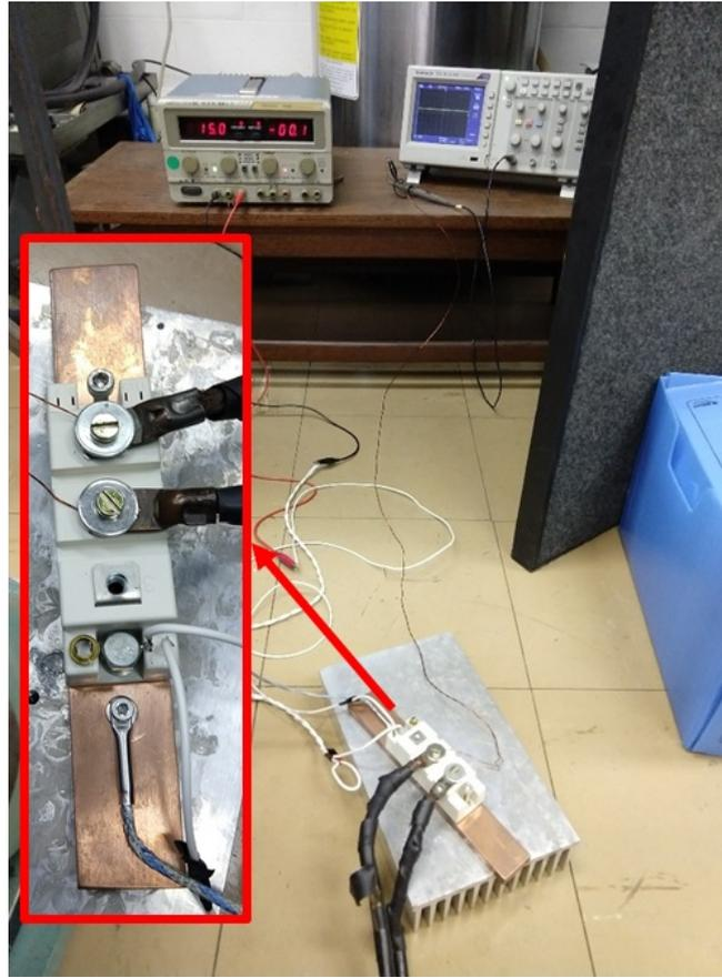
Figura 4.9: Ensaio de condução direta do IGBT BSM50GB60DLC.
