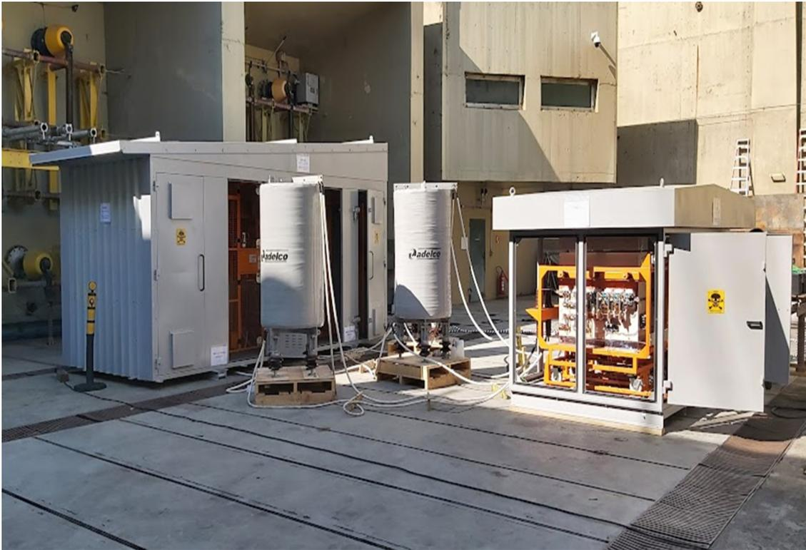
Figura 1.1: Ensaio do LCCEP do tipo série, desenvolvido pela UFF e indústria Adelco, no Laboratório de Alta Potência, unidade Adrianópolis do Cepel.
