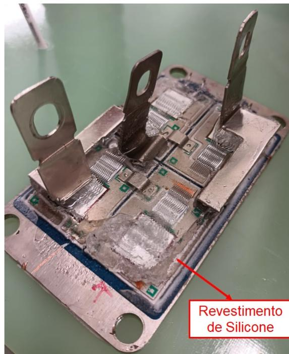
Figura 4.15: Configuração interna do IGBT.
