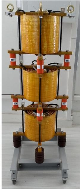
Figura 4.16: RNA usado como  $Z_{shunt}$ .
