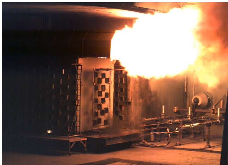
Figura 1.1: Ensaio de arco-elétrico em cubículos de média tensão no laboratório de alta potência do CEPEL
