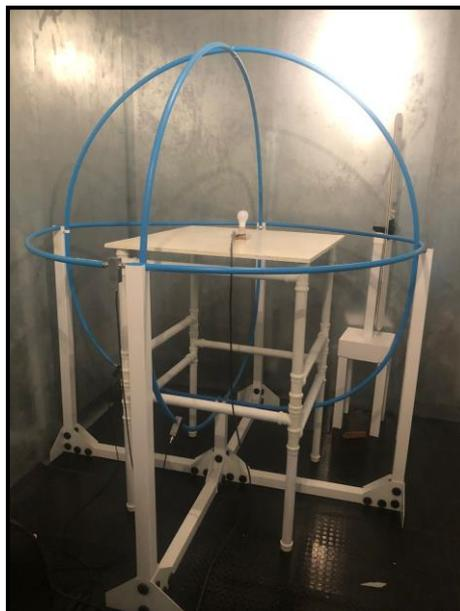
**Figura 38 - Antena *loop* usada nos ensaios.
