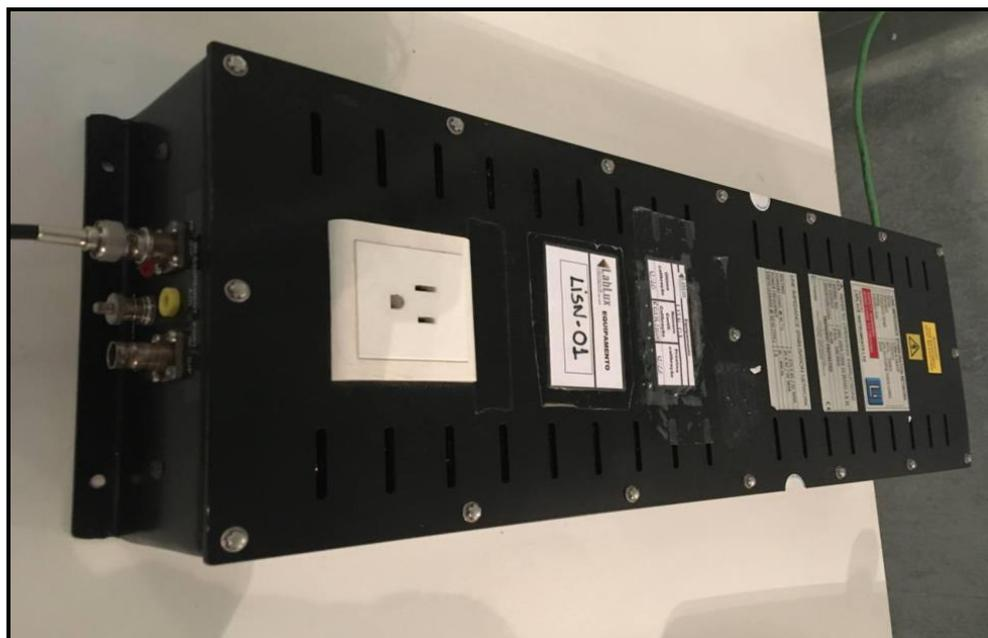
**Figura 32 - LISN usado nos ensaios.**
