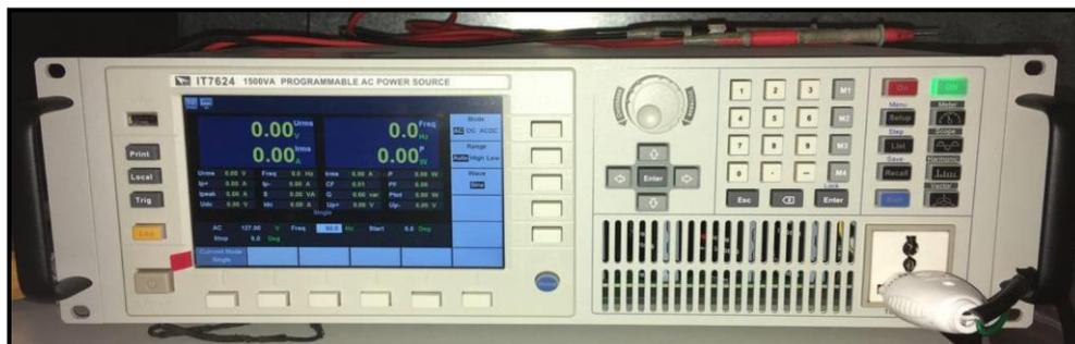
**Figura 31 - Fonte de alimentação CA usado nos ensaios.
