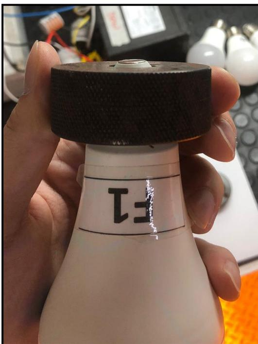
**Figura 24 - Ensaio de verificação de filete de rosca.
