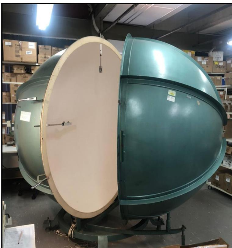
**Figura 21 - Esfera Integradora de Ulbricht.**
