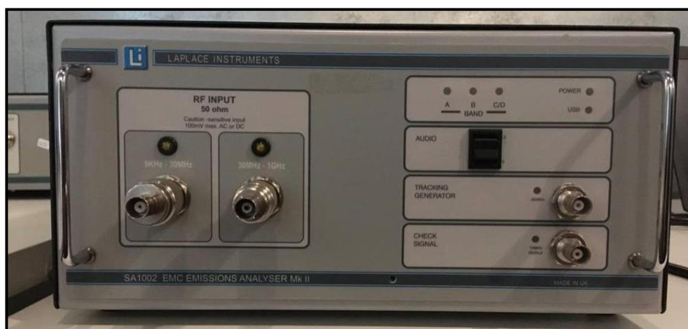
**Figura 35 - Analisador de espectro usado nos ensaios.**
