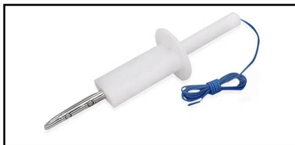
**Figura 16 - Exemplo dedo-padrão usado em ensaios de proteção contra contato.**
