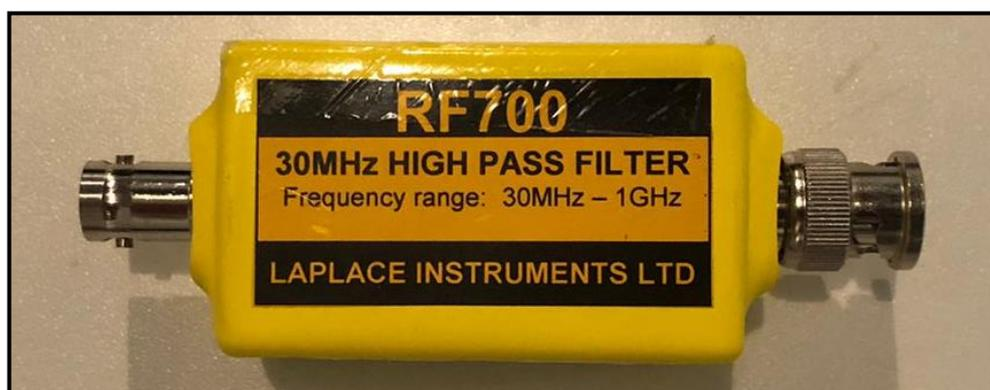
**Figura 37 - Filtro passa-alta usado nos ensaios.**
