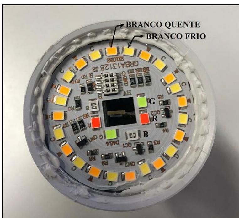
**Figura 4 - PCB lâmpada LED inteligente.**
