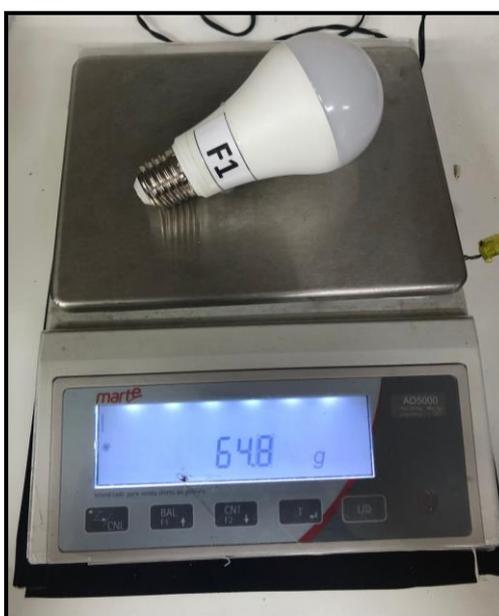
**Figura 27 - Realização da medição de massa da amostra.**
