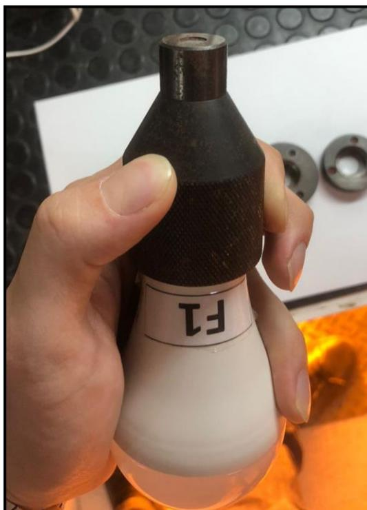
**Figura 30 - Ensaio com gabarito para proteção de contato partes vivas.
