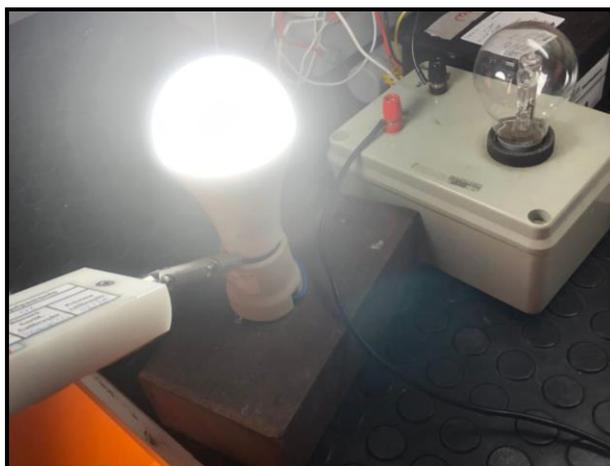
**Figura 28 - Ensaio de proteção contra contato partes vivas.
