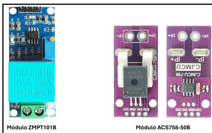
**Figura 34 – Do lado esquerdo da figura o módulo ZMPT101B utilizado para medição de tensão, do lado direito o módulo ACS758-50B utilizado para medição da corrente.**
