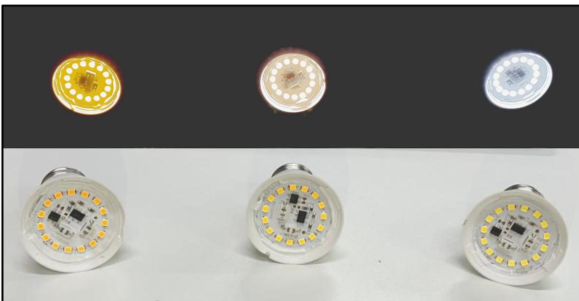
**Figura 14 – Técnica de conversão por fósforo utilizado em lâmpadas LED.**
