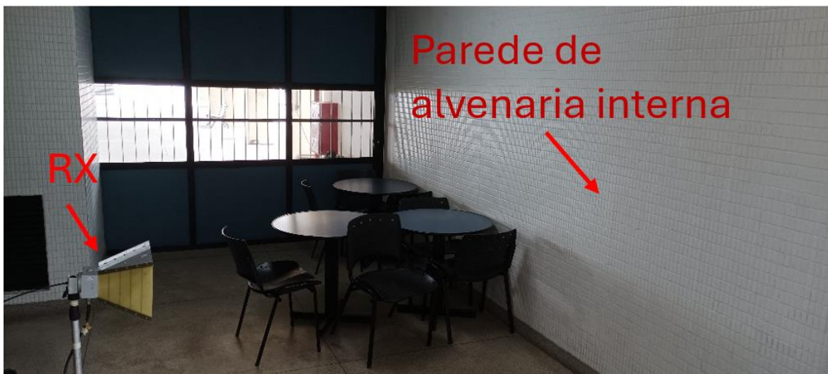
Figura 4.7: Parede de alvenaria para medição da perda de penetração outdoor x indoor, com a antena de Rx.
