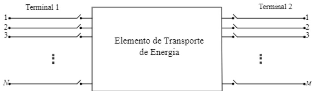
**Figura 17 - Elemento de transporte de energia com dois terminais, o primeiro com N conectores e o segundo com M conectores. (Fonte: EPRI, 2016)**
