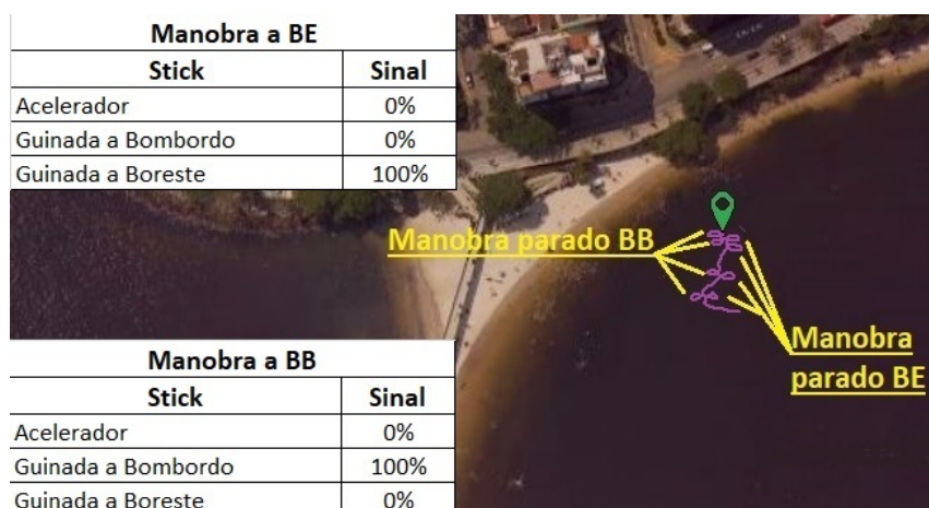
Figura 5.14: Embarcação parada, Manobras para BB e BE com PWM em 0 % para o acelerador e guinadas máximas para BB e BE.
