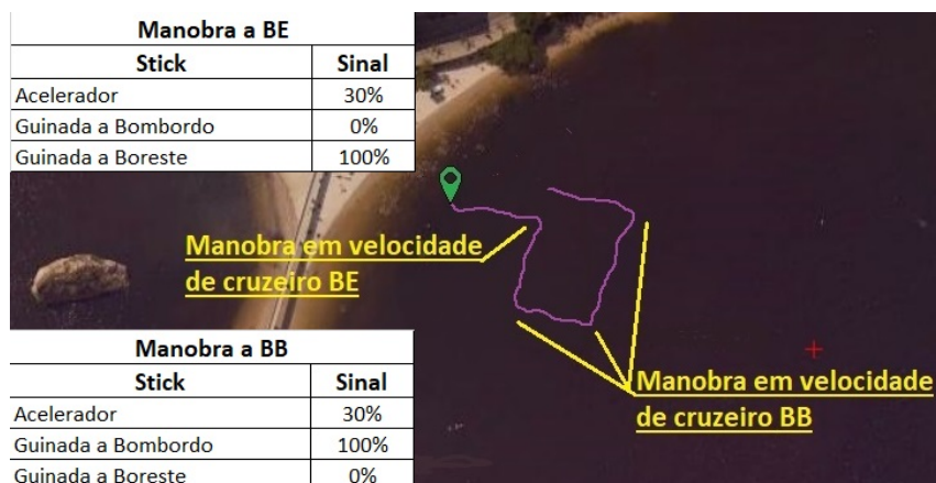
Figura 5.13: Navegação em velocidade de cruzeiro, Manobras para BB e BE com PWM em 30 % para o acelerador e guinadas máximas para BB e BE.
