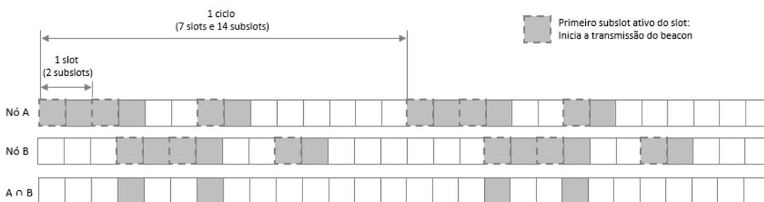
**Figura 8 - Exemplo de funcionamento do modelo bidirecional para o escalonamento com *Block Design* de  $\{7, 3, 1\}$ , divisão em 2 *subslots* e *offset* de 1,5 *slot*.**
