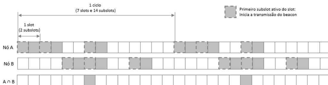
**Figura 9 - Exemplo de funcionamento do modelo bidirecional proposto para o escalonamento com *Block Design* de {7, 3, 1}, divisão em 2 *subslots* e *offset* de 2 slots.**
