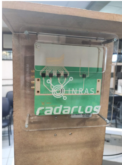
Figura 3.14: Radar MIMO FMCW utilizado para coleta de dados.
