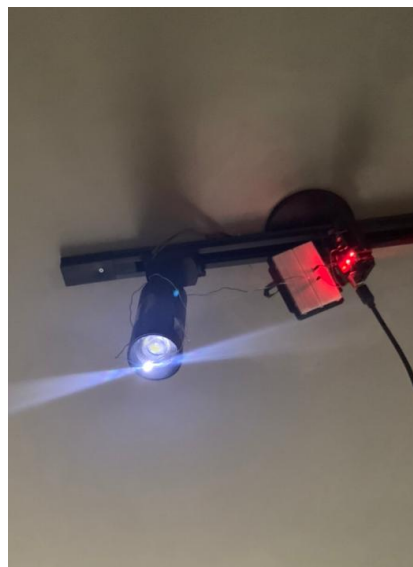
Figura 4.10: Montagem para análise de perfil de intensidade luminosa Fonte: Autoria Própria
