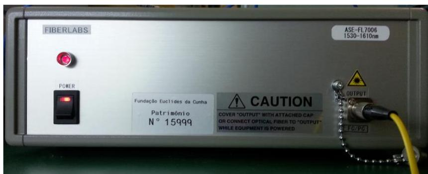
Figura 2.12 - Imagem frontal de uma fonte utilizada na configuração experimental.
