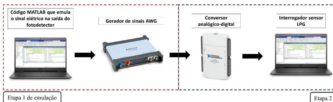
Figura 4.10 - Novo modelo de configuração experimental para aquisição de dados da técnica de interrogação do sensor baseado em LPG.
