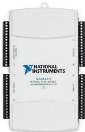
Figura 2.20 - Placa de aquisição da *National Instruments* modelo NI USB – 6216.
