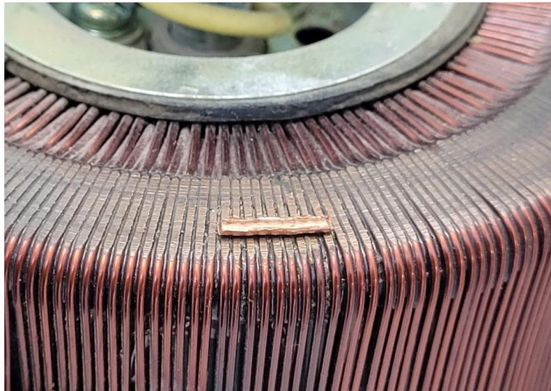
Figura 5.10: Ilustração do método de aplicação de um curto de 4,65% aplicado ao enrolamento.
