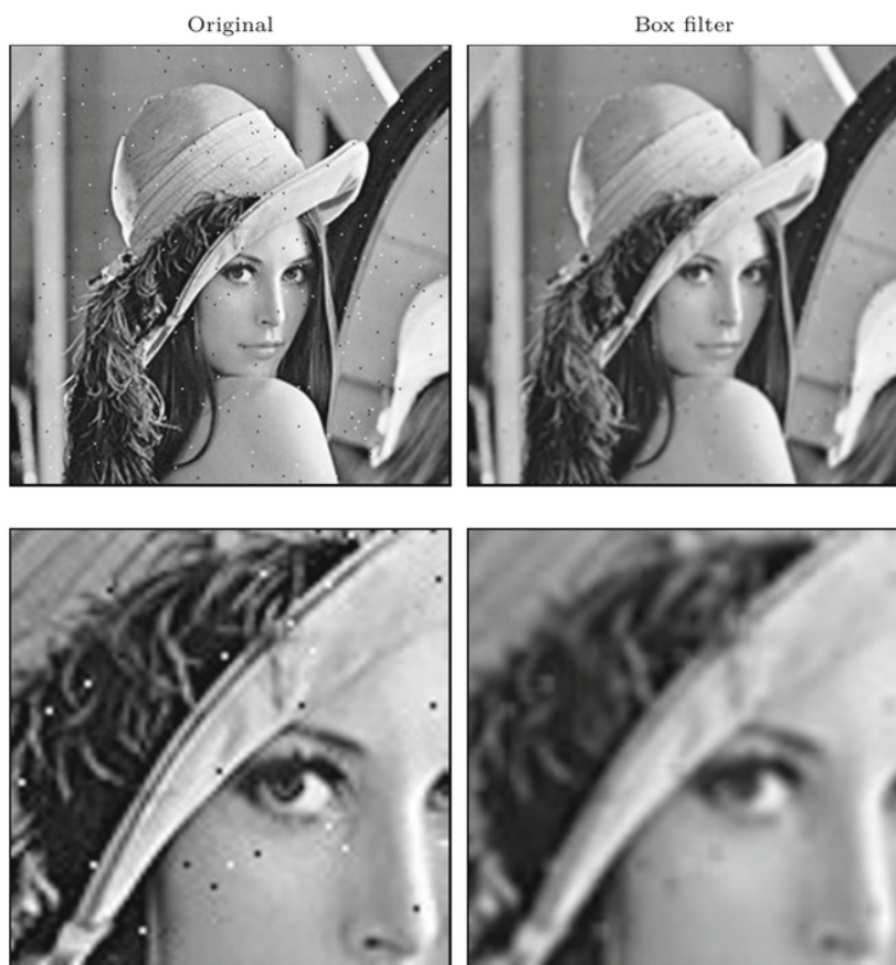
Figura 2.3: Exemplo da aplicação do filtro linear 3 \times 3 em uma imagem em escala de cinza. Fonte: [2].
