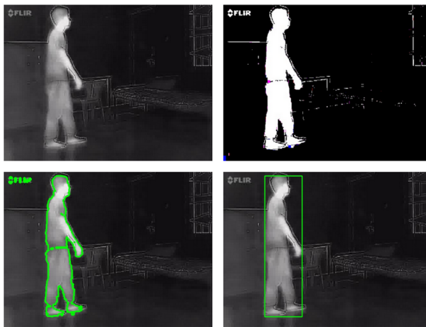
Figura 3.8: Quadros resultantes da técnica de rastreamento da região de interesse proposta por Mehta et al para câmeras térmicas. Fonte: [9]
