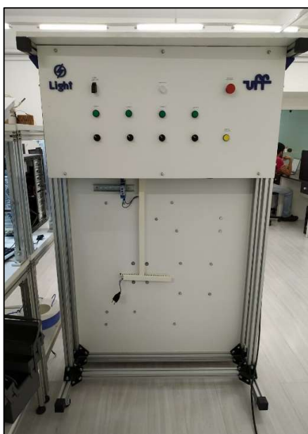
Figura 40 - Rack de cargas, parte frontal. FONTE: Elaboração Própria.
