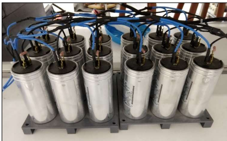
Figura 33 - Banco de capacitores. FONTE: [54].
