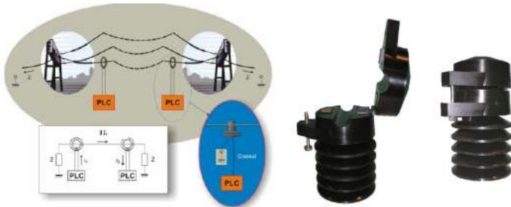
Figura 13 - Acopladores capacitivos instalados na rede Fonte: OPERA. IST Integrated Project n° 026920
