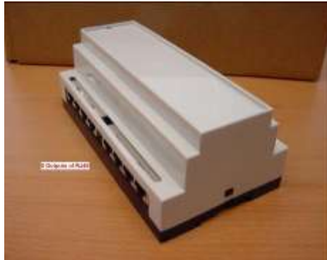
Figura 21 - Splitter com fonte de alimentação externa Fonte: OPERA. IST Integrated Project N° 026920
