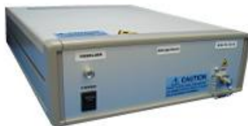
Figura 3-4: Fonte de ASE para bandas C e L.
